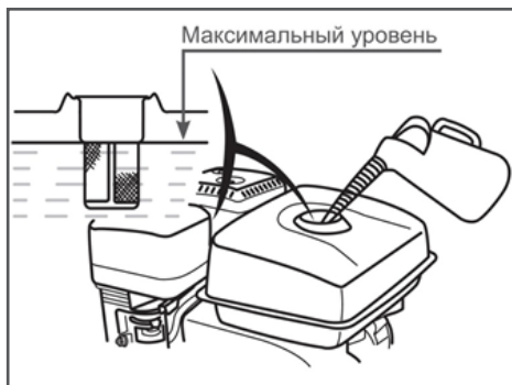
Рис. 7 Максимальный уровень топлива в топливном баке
