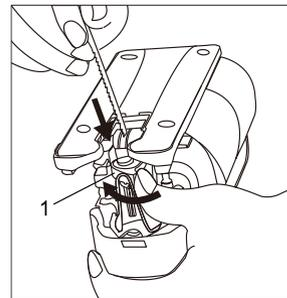
**Установка адаптера для подключения пылесоса**
