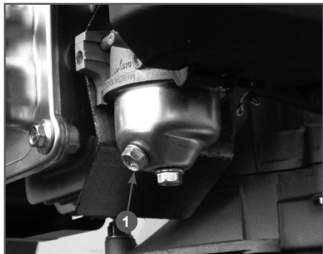
Рис. 16 Слив топлива из карбюратора
