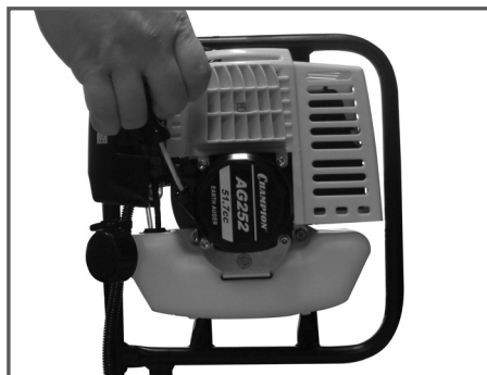
Рис. 7 Свободный ход шнура стартера
