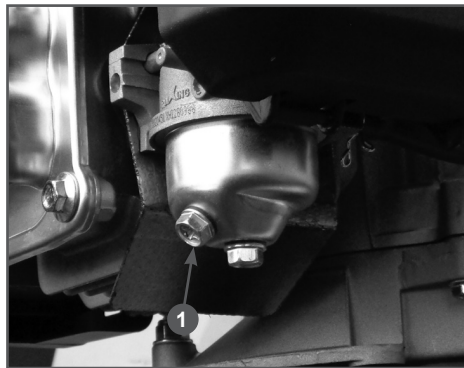
Рис. 19 Слив топлива из карбюратора
