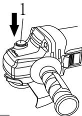
Нажмите на кнопку блокировки (1) для предотвращения вращения шпинделя при установке или снятии дополнительных принадлежностей.
