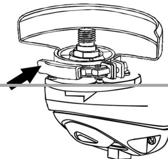
получения увечий и гибели оператора. Кожух диска необходимо устанавливать на инструмент таким образом, чтобы закрытая сторона кожуха всегда находилась по направлению к оператору.
