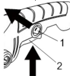
всегда проверяйте, что выключатель работает надлежащим образом и возвращается в положение “ВЫКЛ”, если его отпустить.
