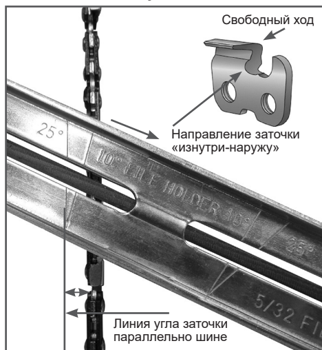
Рис. 23 Расположение линии угла заточки
