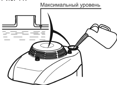
Рис. 11 Максимальный уровень топлива в топливном баке
