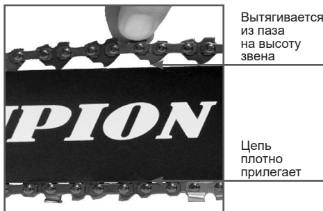
Рис. 5 Регулировка натяжения цепи
