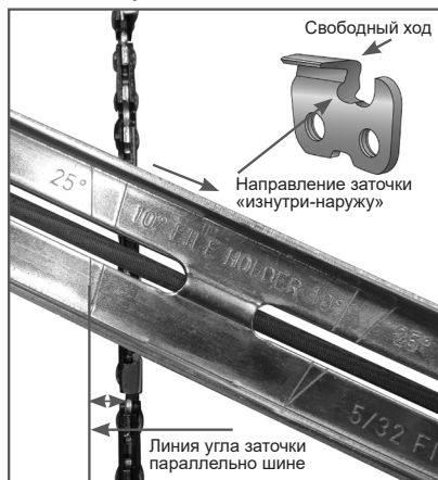
Рис. 28 Определение угла заточки
