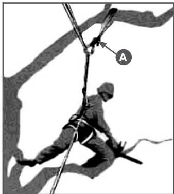
Рис. 21 Положение оператора при горизонтальном пилении
