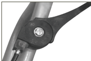
Рис. 11 Положение рычага газа
