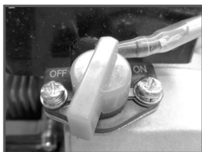
Рис. 12 Установка выключателя зажигания
