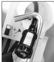
Рис. 15 Извлечение топливного фильтра
