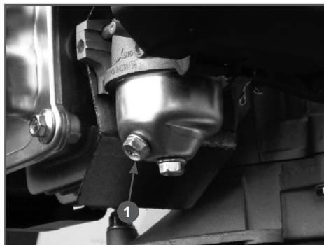
Рис. 19 Слив топлива из карбюратора
