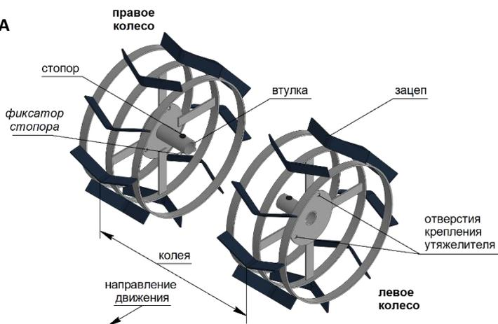
Рисунок 1. Комплект колес с обозначением
