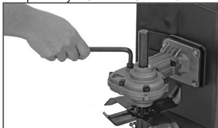
Рис. 7 Проверка смазки в редукторе
