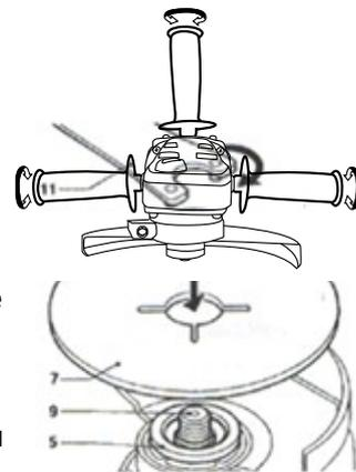
попал в специальное отверстие. В процессе обязательно удерживайте кнопку блокировки шпинделя нажатой;
