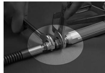
2. Если вы используете удлинительную штангу, вы можете выкрутить переднюю насадку (1) из пистолета-распылителя и соединить удлиненную штангу (2) с пистолетом-распылителем, затем вкрутить насадку в удлинительную штангу.
