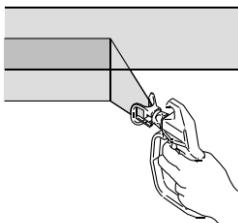
Один из способов получения такого покрытия – направлять распыляющий наконечник брызг на край предыдущего мазка перед тем, как нажать на спусковой механизм краскораспылителя.
