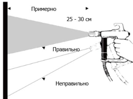
4. В большинстве случаев лучшее расстояние при распылении составляет 10 - 12 дюймов (25-30 см) между распыляющим наконечником и краскораспылителем.
