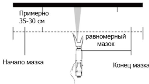
6. Правильная скорость перемещения распылителя обеспечивает нанесение качественного влажного покрытия без подтеков. Мазки должны перекрывать друг друга примерно на 40%, это позволит получить равномерную толщину наносимого покрытия. Равномерное распыление краски слева направо и справа налево дает профессиональное качественное покрытие. (См. рисунок ниже)
