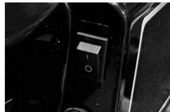
7. Выключите питание. Поднимите клапан заливки/распыления в положение распыления. Направьте краскораспылитель в пустое ведро.
