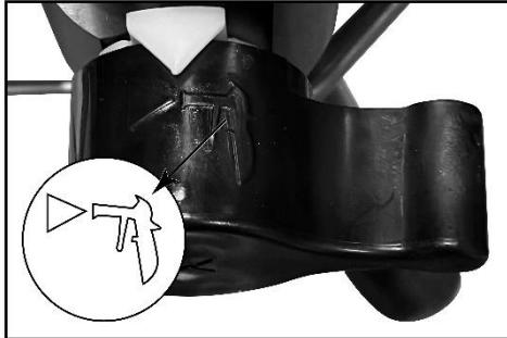
8. Нажмите переключатель в положение ON. Продолжайте запускать пистолет в ведро для отходов, пока не увидите, что из пистолета выходит только краска. Отрегулируйте регулятор давления против часовой стрелки до желаемого давления. Откройте крышку панели, вы увидите изменение давления на дисплее.
