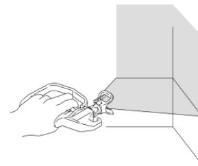
8. При окрашивании внутренних углов, например, в книжном шкафу, направьте краскораспылитель в центр окрашиваемого угла, это позволит равномерно окрасить края с обеих сторон
