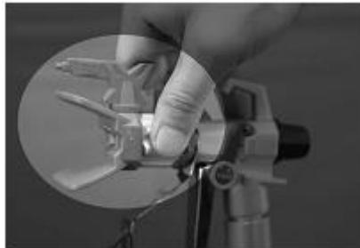
Для достижения хороших результатов распыления очень важно использовать распыляющий наконечник хорошего качества подходящий по размеру для распыляемой Вами жидкости. Распыляющий наконечник управляет количеством наносимой краски и площадь пятна распыления. Вы можете использовать широкий ряд размеров наконечников, различающихся по размеру отверстия и ширине пятна распыления, выбрав необходимый с учетом 3 факторов:
