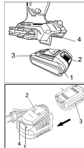
произойдет. При этом индикатор (1) будет гореть зеленым после подключения зарядного устройства к батарее. Если аккумуляторная батарея повреждена, процесс заряда батареи не произойдет. При этом индикатор (1) будет гореть зеленым после подключения зарядного устройства к батарее.
