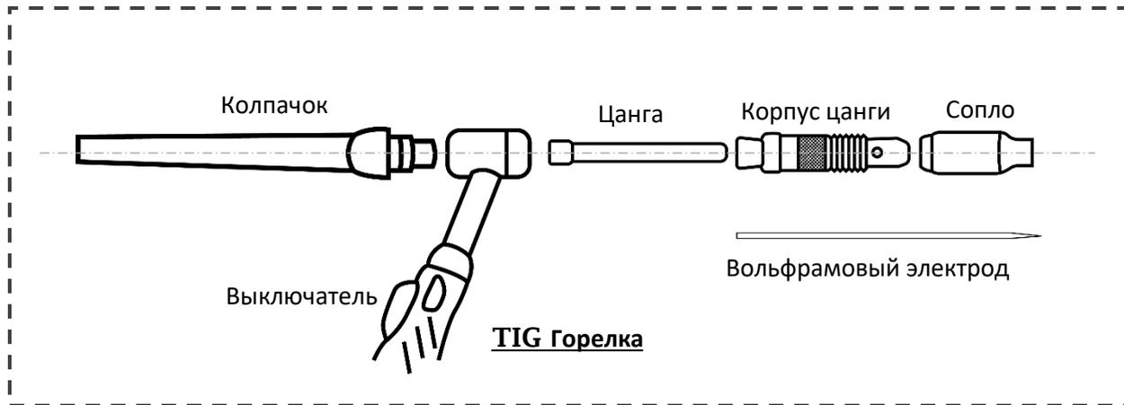
**Диаметр электрода зависит от сварочного тока:**
