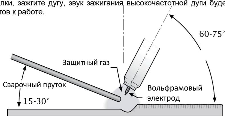
**TIG СВАРКА МЕТОДОМ ПЛАВЛЕНИЯ:**
