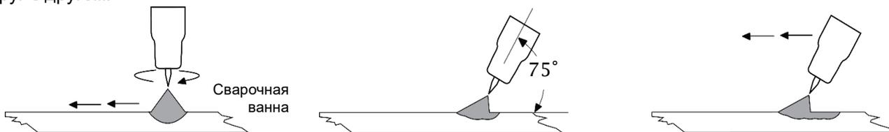
**TIG СВАРКА С ИСПОЛЬЗОВАНИЕМ СВАРОЧНОГО ПРУТКА**
