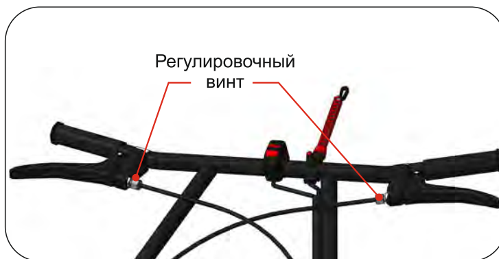
Рис. 22. Регулировка дросселя заслонки газа и натяжки тормозной ленты (опционно).
