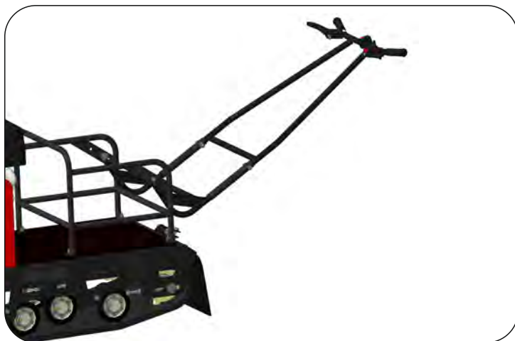
Рис. 18. Регулировка руля МБС 1, МБС 2, МБС 3, МБС 5.
