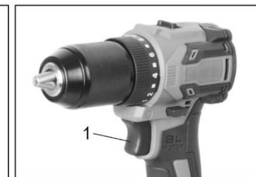
**ВНИМАНИЕ!** в данных шуруповертах производителем предусмотрена электронная защита от перегрузки, которая полностью отключает питание изделия от АКБ в случае достижения предельных значений. По истечении времени (около 30с) работоспособность изделия восстанавливается (защита разблокируется) автоматически, изделие пригодно к работе.
