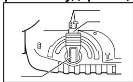
Для сверления в бетоне и каменной кладке нажмите кнопку блокировки и поверните ручку изменения режима действия к символу
