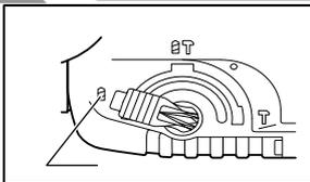
Для сверления в дереве, металле или пластиковых материалах, нажмите кнопку блокировки и поверните ручку изменения режима действия к символу
