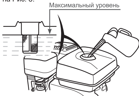
Рис. 8 Максимальный уровень топлива в топливном баке
