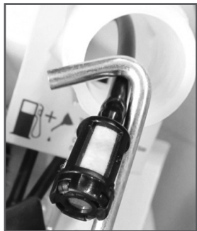
Рис. 14 Извлечение топливного фильтра
