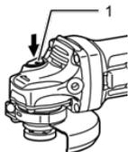
**ВНИМАНИЕ!** Никогда не задействуйте блокировку при вращающемся шпинделе. Это может привести к повреждению инструмента. Нажмите на кнопку блокировки для предотвращения вращения шпинделя при установке или снятии дополнительных принадлежностей.
