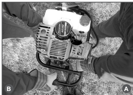
Рис. 10. Положение рук при работе вдвоем
