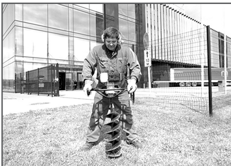
Рис. 8. Положение тела оператора при работе мотобуром
