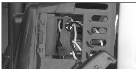
Рис. 6. Рычаг управления воздушной заслонки
