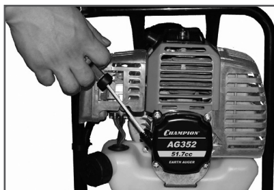
Рис. 7. Свободный ход шнура стартера
