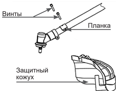
Рис. 3 Установка защитного кожуха
