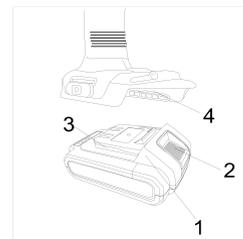
Рис. 3 Снятие аккумулятора.
