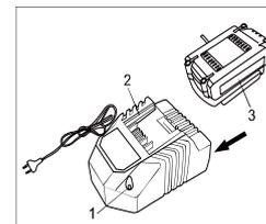
Рис. 4 Зарядка аккумулятора.
