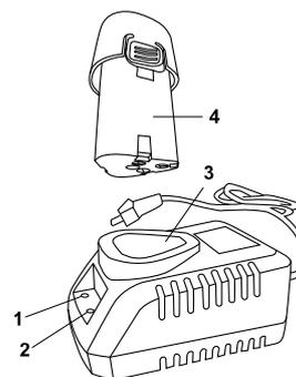
**ВНИМАНИЕ!** Чтобы сохранить работоспособность Li-ion батареи, она не должна заряжаться при температуре ниже 0°C или выше 45°C. Если температура аккумуляторной батареи выше 45° или ниже 0°C, процесс заряда батареи не произойдет. При этом индикатор (1) будет гореть зеленым после подключения зарядного устройства к батарее. Если аккумуляторная батарея повреждена, процесс заряда батареи не произойдет. При этом индикатор (1) будет гореть зеленым после подключения зарядного устройства к батарее.
